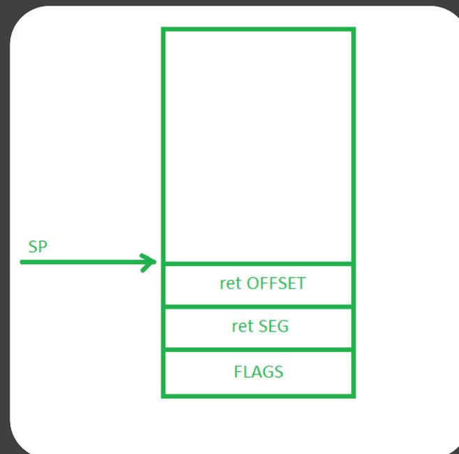
После выполнения оригинального обработчика прерывания:
